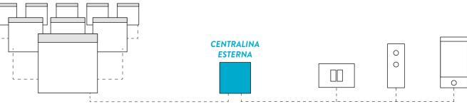
VBE è un sistema ad alta precisione gestito da innovativa centrialina esterna e lavora con motore encoder 24V DC.
